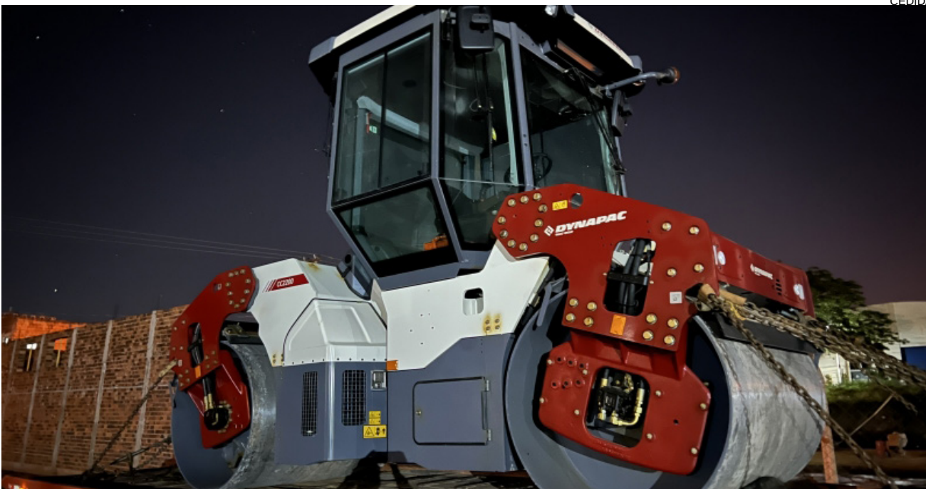
Primeiro rolo que chegou foi uma unidade vibratória tandem com duplo cilindro da marca Dynapac
