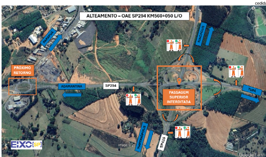
Elevação da altura vai adequar viaduto contra risco de colisão por cargas mais altas.
