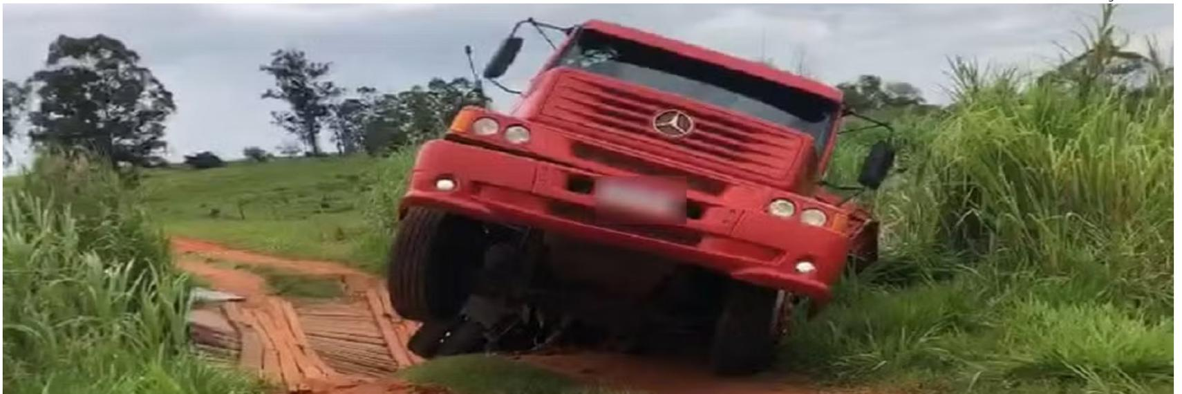
Estrutura da ponte não suportou pesos do veículo e da carga
